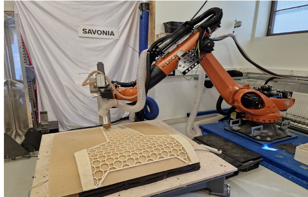
Kuva: Savonia FGF robottitulostussolu + ei-tasomainen tarkastustyökalu -tuloste
